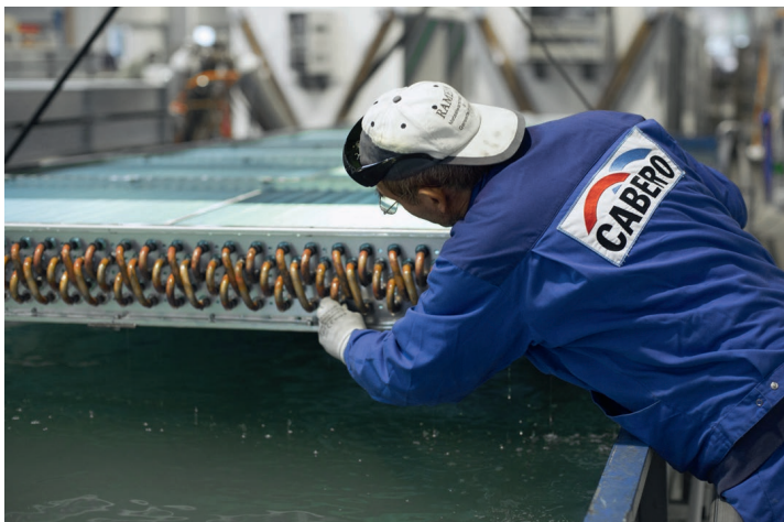
最终检查检测池
